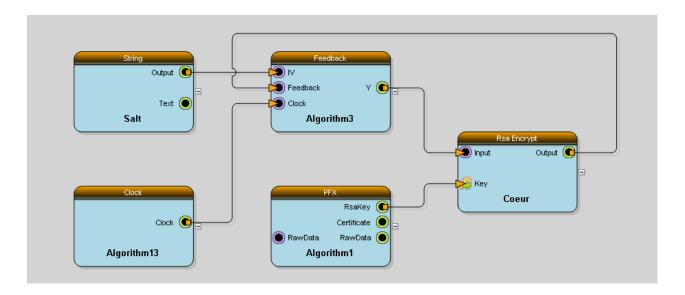
Le module Feedback permet la fonction suivante : Y =entrée IV pour t=0, sinon Y =entrée Feedback pour t = n\*T où T est la période de l'horloge Clock et n est un entier.
